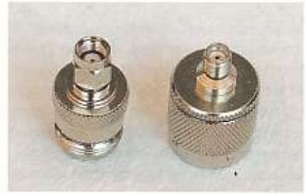
Adapter RP-SMA naar female-N (links) en adapter normale SMA naar male-N (rechts).
